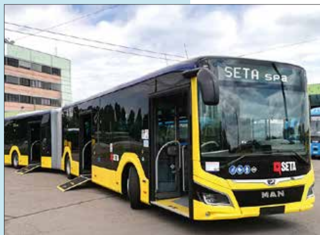
Nella foto, uno dei nuovi bus autosnodati Man Lion's City da 18 metri di lunghezza a metano compresso Cng, con allestimento per servizio urbano, in servizio in città
