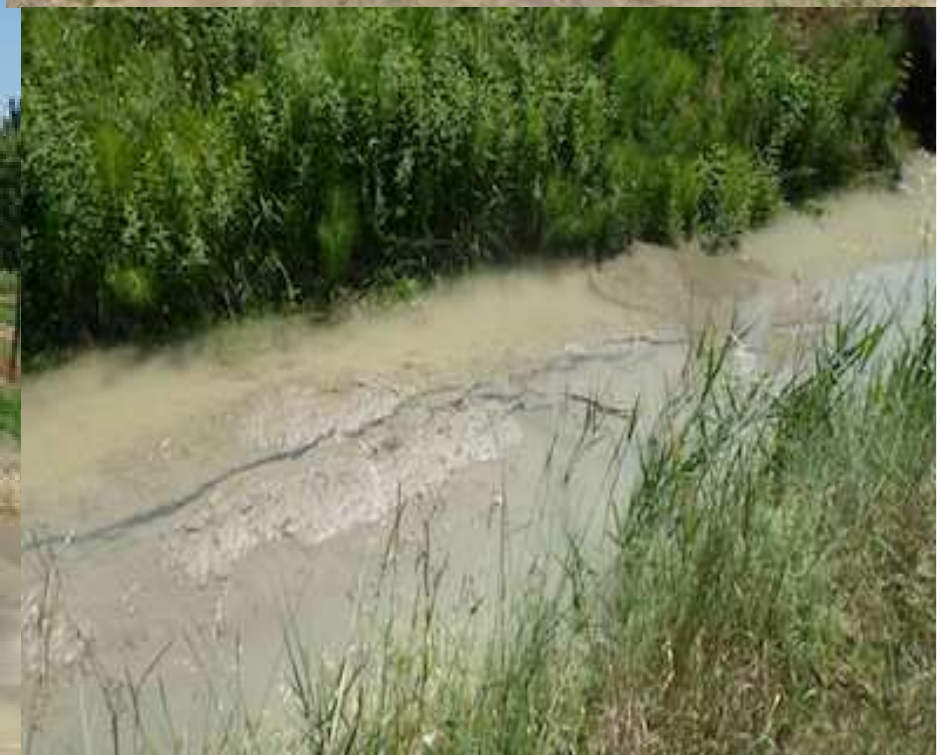
Uccivello (Cavezzo), zona epicentro sisma del 29/05/2012 : Liquefazione del 29/5/2012
