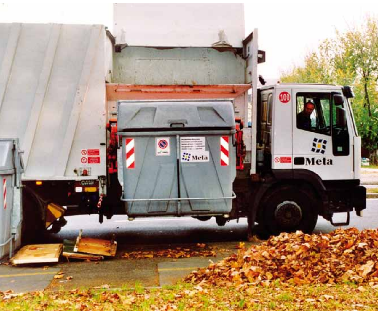
Mezzo per lo svuotamento dei cassonetti dei rifiuti a caricamento laterale e operatore unico (Archivio META S.p.A.-Hera S.p.A.)
