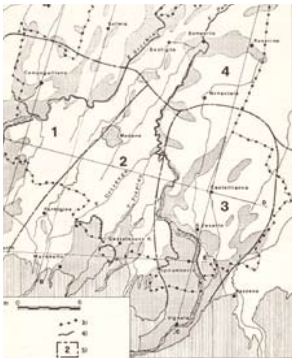
Figura 3 - Idrografia dell'alta pianura modenese (da Piano per la Tutela e l'Uso delle Risorse Idriche , Consorzio di Modena, 1981) Legenda: 1) area collinare ove affiorano le formazioni prevalentemente impermeabili; 2) zone di alimentazione delle falde; 3) limite di comprensorio; 4) limite di affioramento delle ghiaie; 5) delimitazione con relativa numerazione delle 4 unità idrogeologiche che interessano il comprensorio di Modena.
