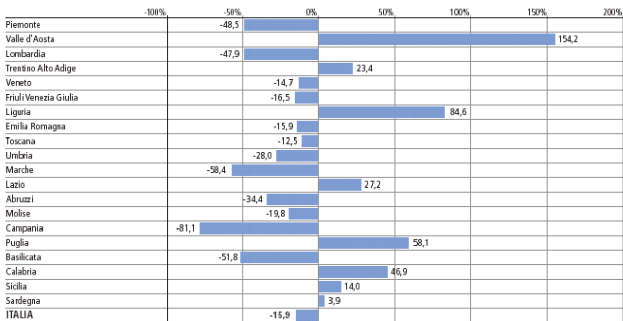
Fig. 4.35 - Superi e deficit della produzione di energia elettrica rispetto alla richiesta in Italia nel 2003
